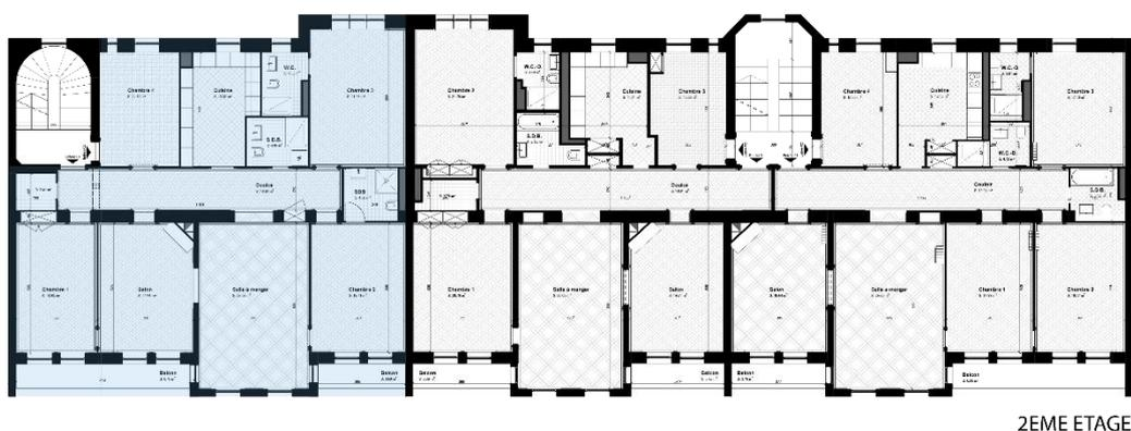
Figure 32 – Bâtiment Mon-Loisir 11, 13 – Plan 2<sup>ème</sup> Etage – Proposition de transformation
